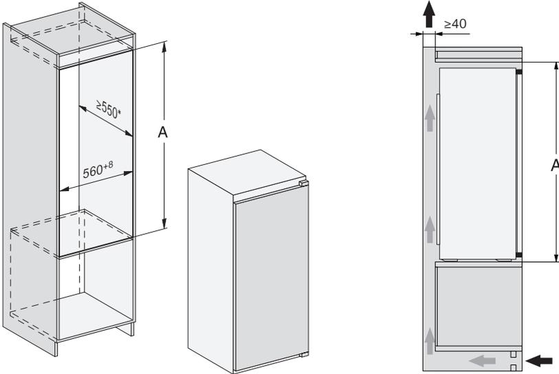
\* Der deklarierte Energieverbrauch wurde mit einer Nischentiefe von 560 mm ermittelt. Das Kältegerät ist bei einer Nischentiefe von 550 mm voll funktionsfähig, hat aber einen geringfügig höheren Energieverbrauch.
