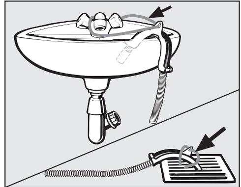
⚠ Schäden durch auslaufendes Wasser.
