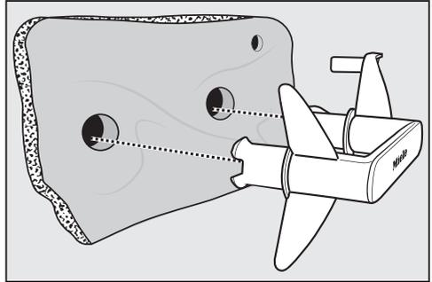
Die Verformungen deuten darauf hin, dass der Sockelfilter verschlissen ist.
